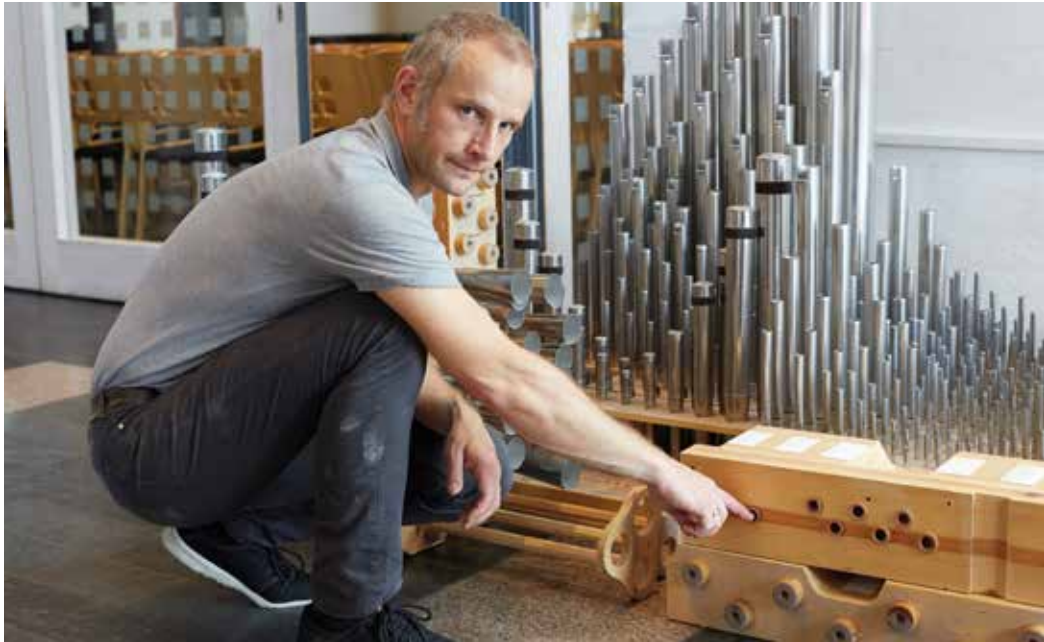
Pakningene på undersiden av pipestokken sikrer at lufta kommer til riktig pipe.
